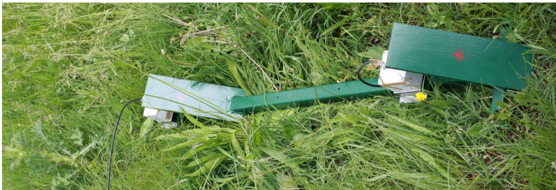
Figura Sistemul de microfoane sensibile la unde de șoc
